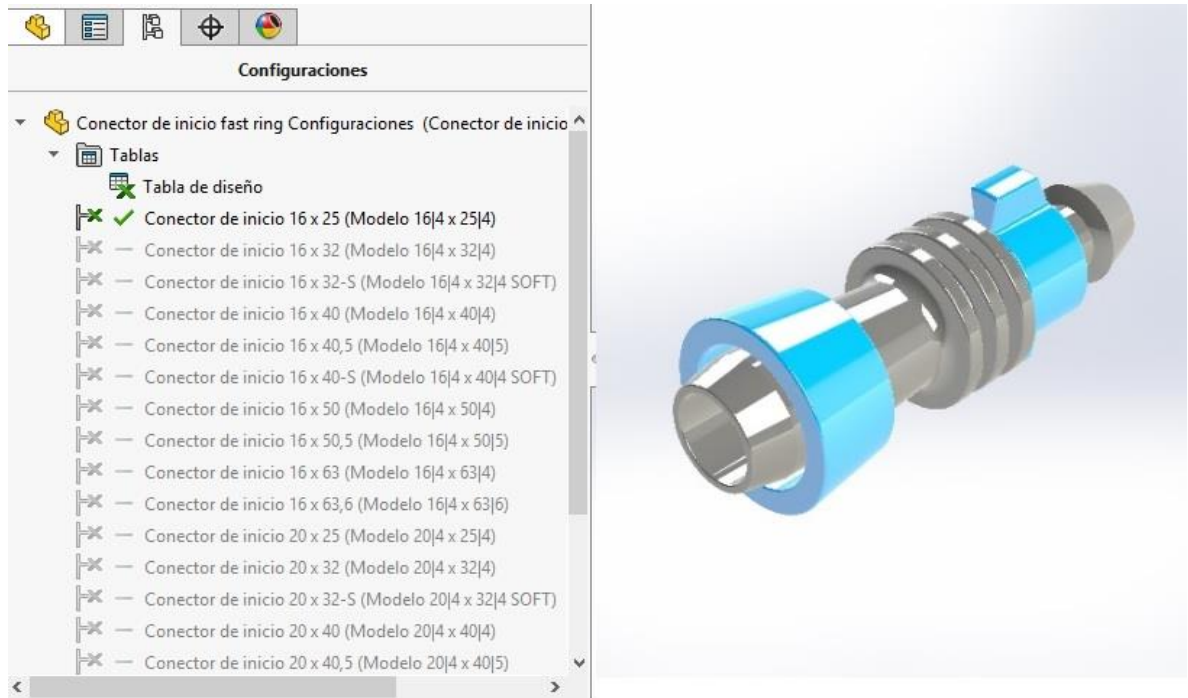
Figura 90. Familia de piezas y Modelo 3D CAD - Conector de inicio.
