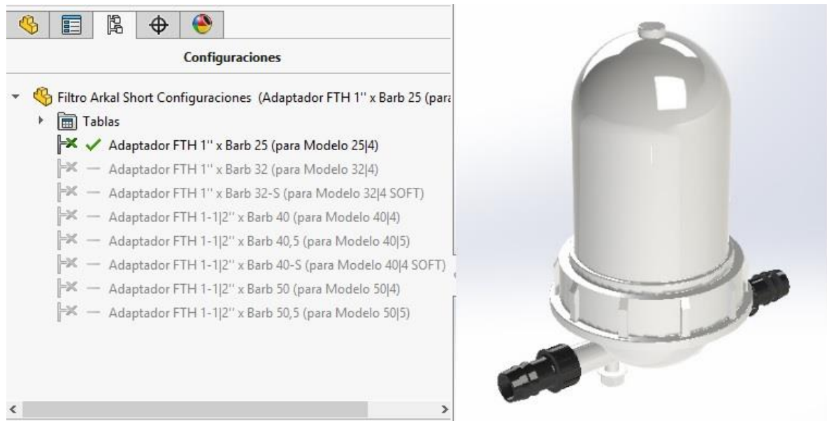
Figura 93. Familia de piezas y Modelo 3D CAD - Filtro de anillos manual.
