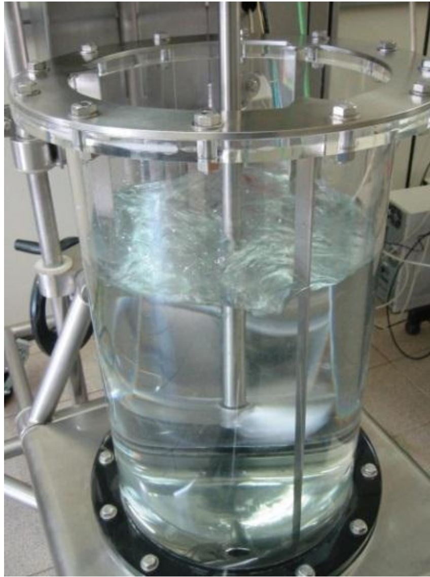
Tanque planta piloto en el proceso de agitación
