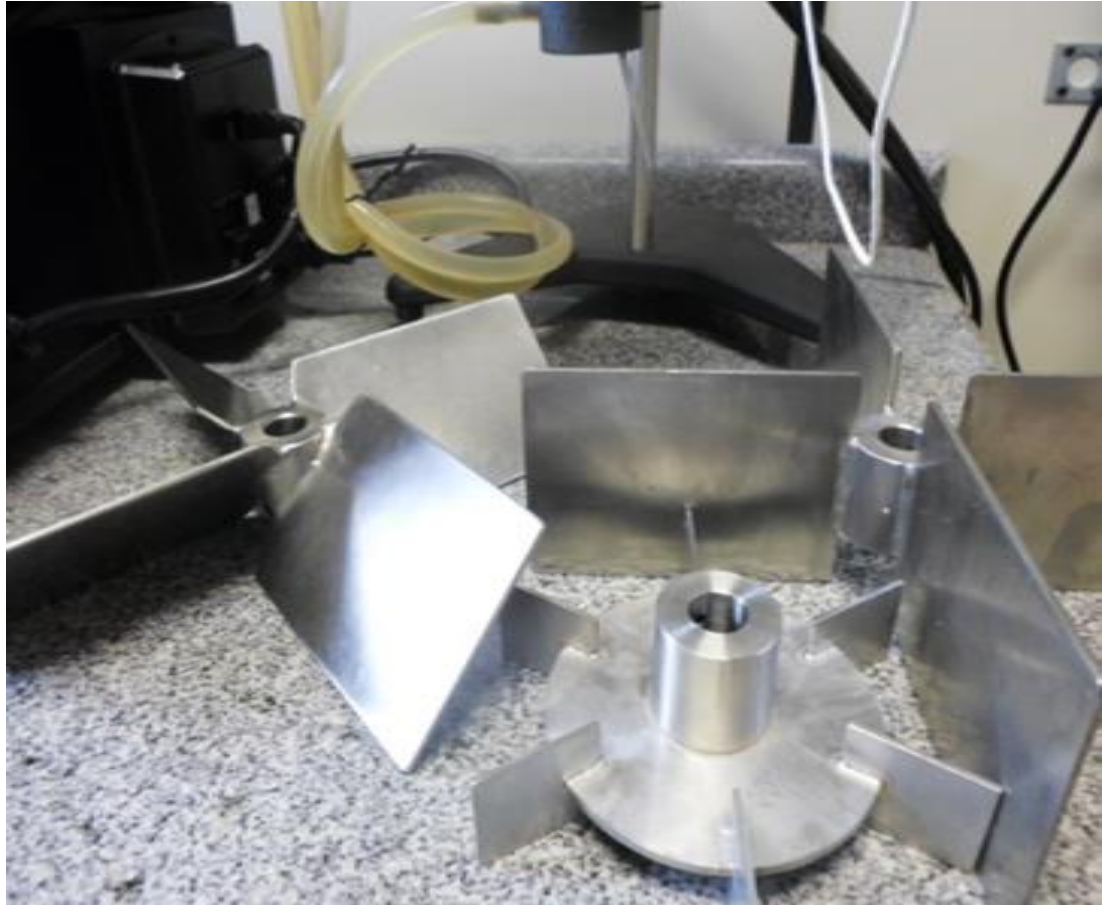
Agitadores del laboratorio rushton aspás rectas y aspás inclinadas experimental
