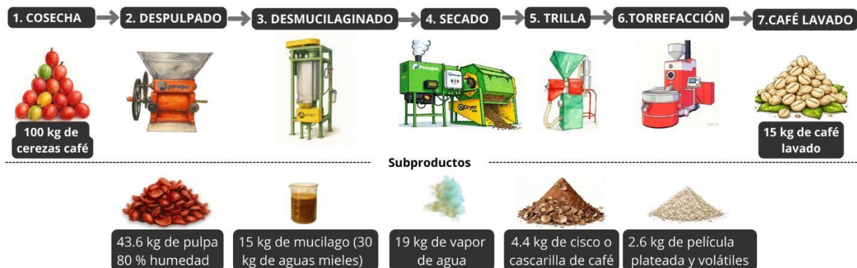
Figura 2 Diagrama del beneficio húmedo del café y subproductos generados por etapas.
