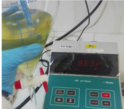
Figura 36. Medición de pH al biodiésel.
