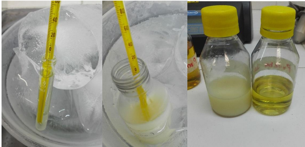
Figura 46. Prueba Punto de Nube.
