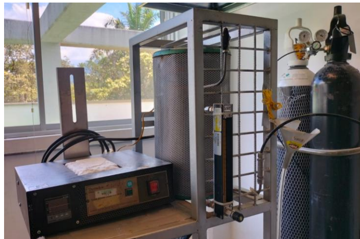
Figura 9 Banco reactor de pirolisis
