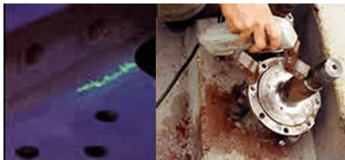
Figura 22: Fallas detectadas por la técnica de partículas magnéticas. Fuente: www.google.com.co /imagenes ensayos no destructivos
