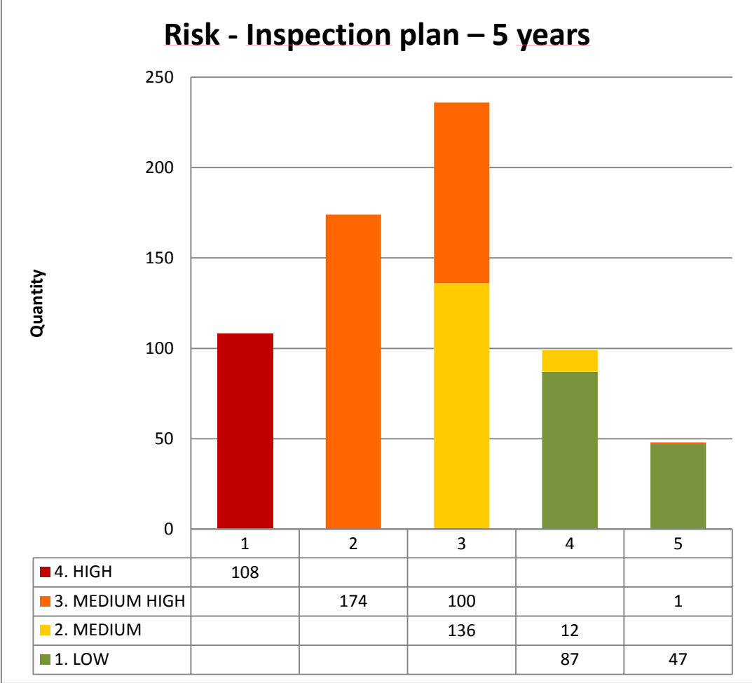
Figura 27: plan de inspección a 5 años, abarcando la totalidad de los equipos. Fuente: tomado de informe RBI Tecnicontrol S.A.
