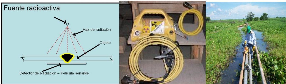
Figura 24: Esquema, equipo y trabajo de campo en la examinación mediante la técnica radiografía industrial. Fuente: www.google.com.co/imagenes ensayos no destructivos
