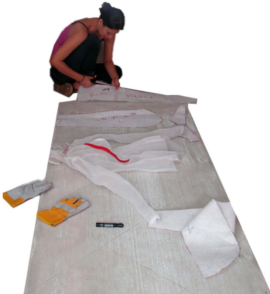
Figura 57. Fotografía del proceso del corte del angeo de alambre. Colaboración por parte de la compañera Paola Correa Meneses.
