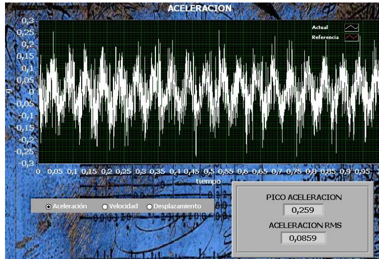
FIGURA E-3. Señal de Aceleración en el tiempo adquirida por el sensor en el Eje Y. Motor estado normal
