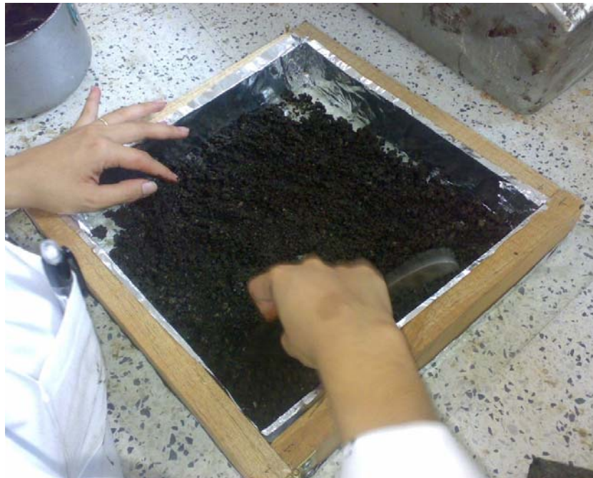
Figura 12. Colocación de la Mezcla en el Molde
