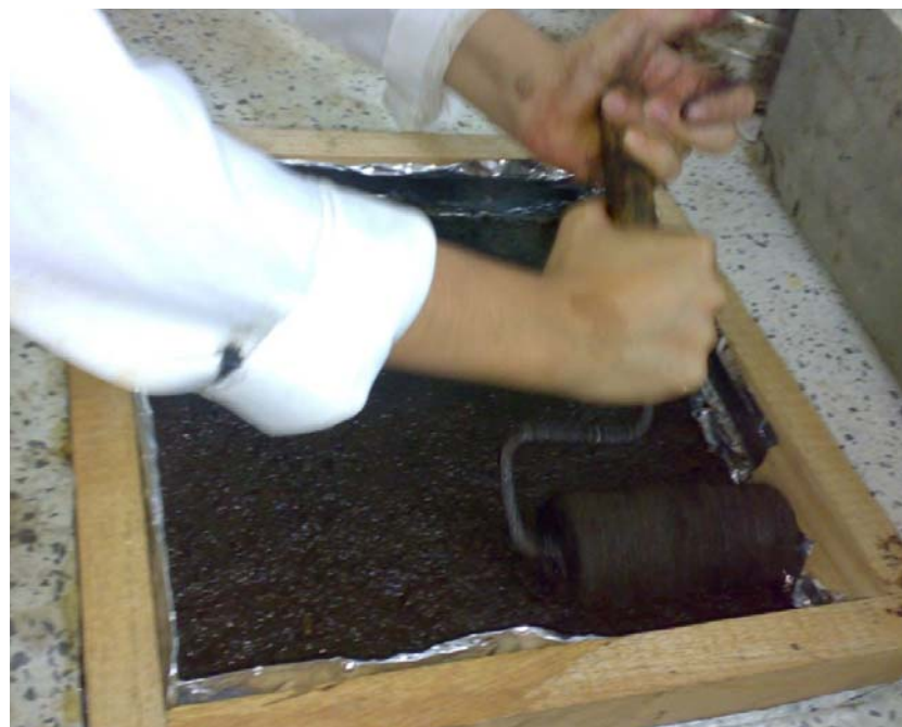
Figura 13. Compactación Manual de la Mezcla
