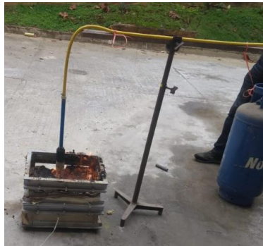
Imagen 18. Simulación de campo Aplicando Temperatura
