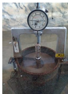
Imagen 9. Medición de la Expansión de la probeta.
