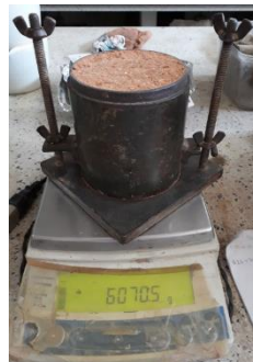
Imagen No 22. Masa del molde más la base y el suelo compactado.
