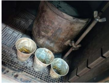
Imagen 11. Tratamiento Térmico para Probetas de CBR.
