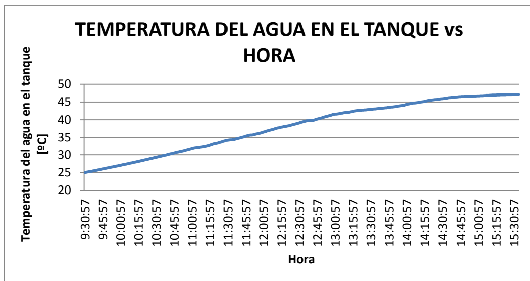
Figura 56. Curva teórica de la temperatura del agua en el tanque con 18 tubos de vacío y 5% de pérdidas de energía en el tanque.*
