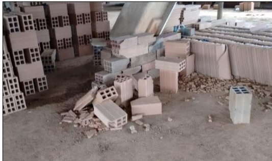
Imagen 7. Ladrillos en mal estado en zona de almacenamiento.
