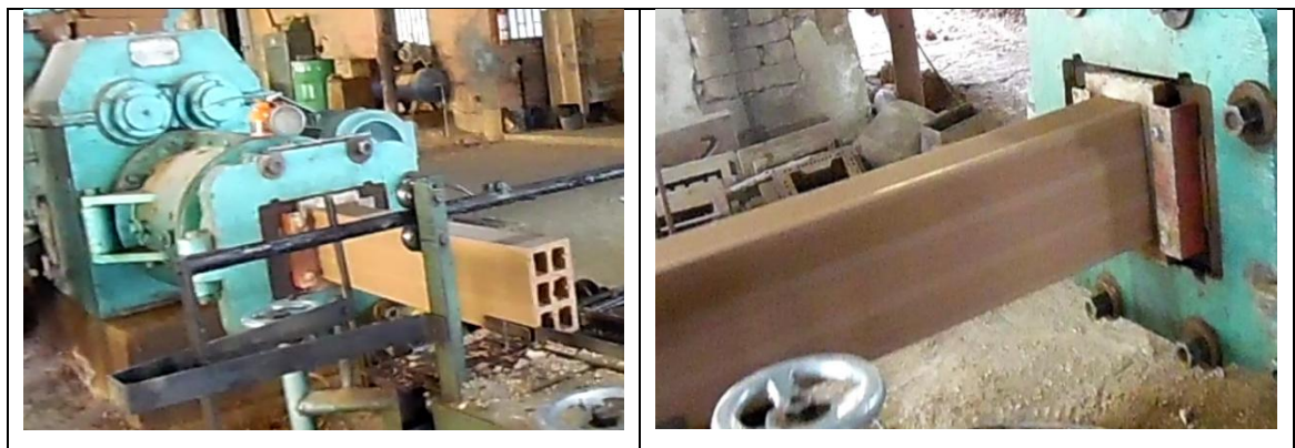
Imagen 3-4. Extrusión al vacío
