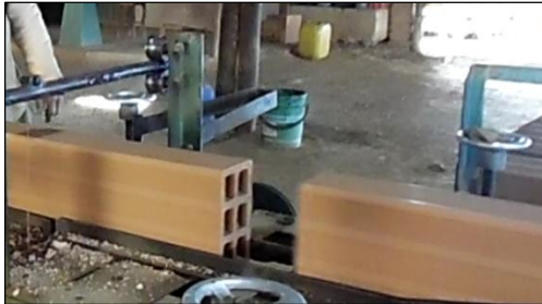
Imagen 5. Corte de material en una barra
