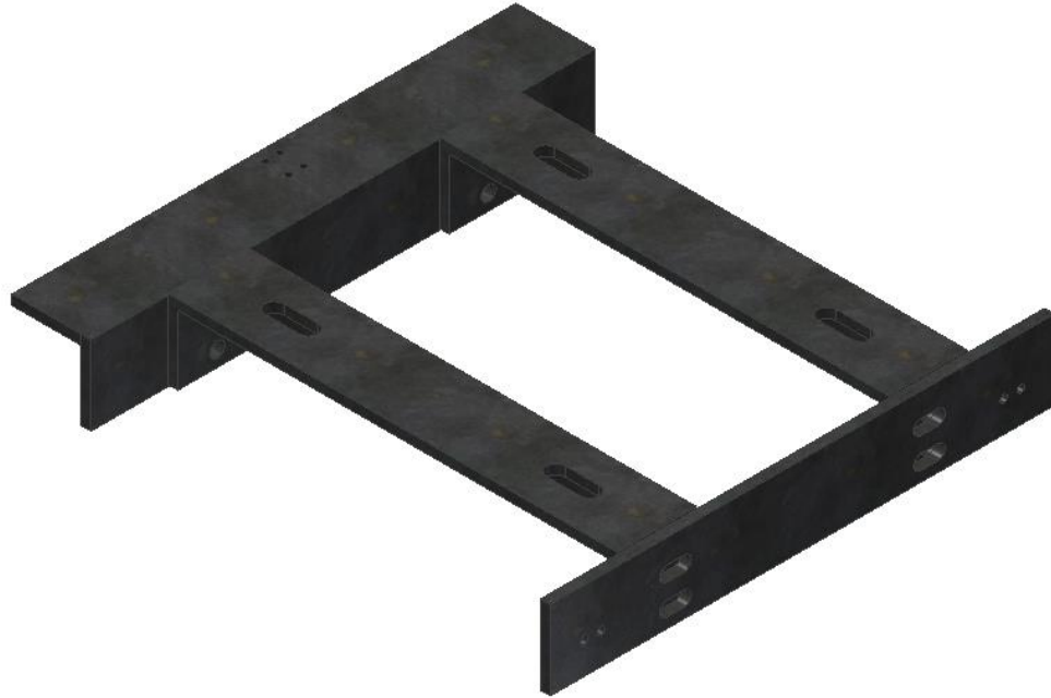
Figura 99 Plataforma sección motor.
