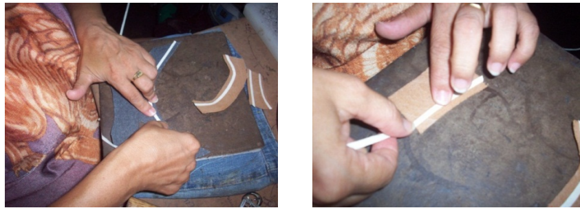
Figura 65: Postura del hiladillo en las piezas críticas de esfuerzo.
