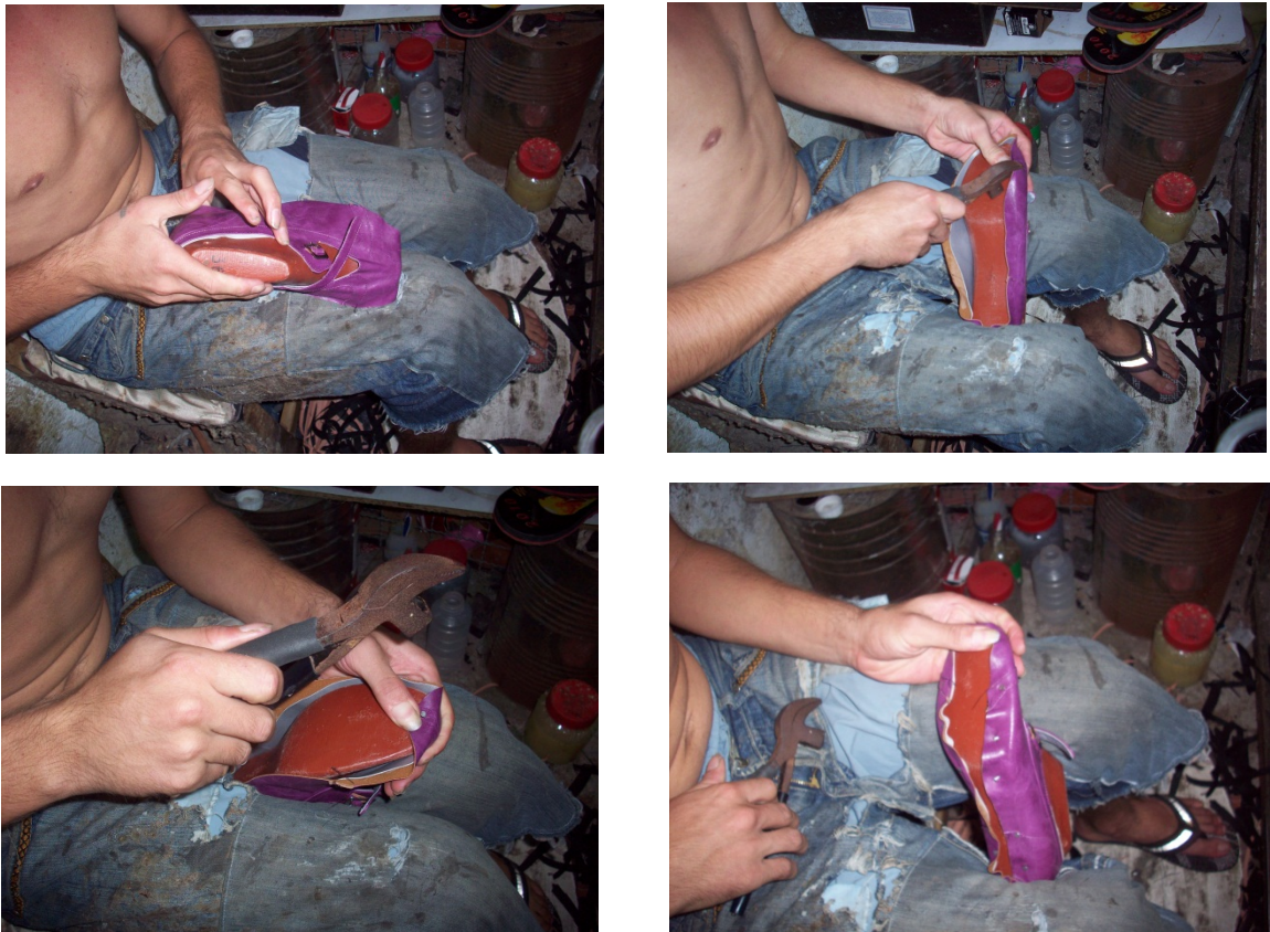
Figura 69: Proceso de montado de la capellada en la horma
