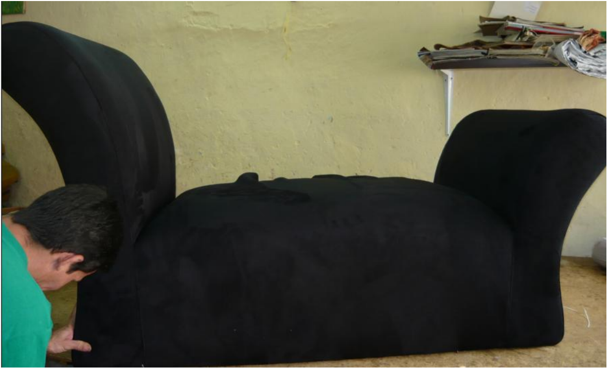
Foto 9. Se pega la tela a la estructura del mueble con ganchos
