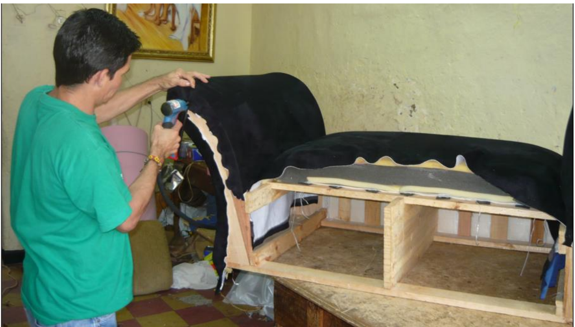
Foto 8. Se pega la tela a la estructura del mueble con ganchos
