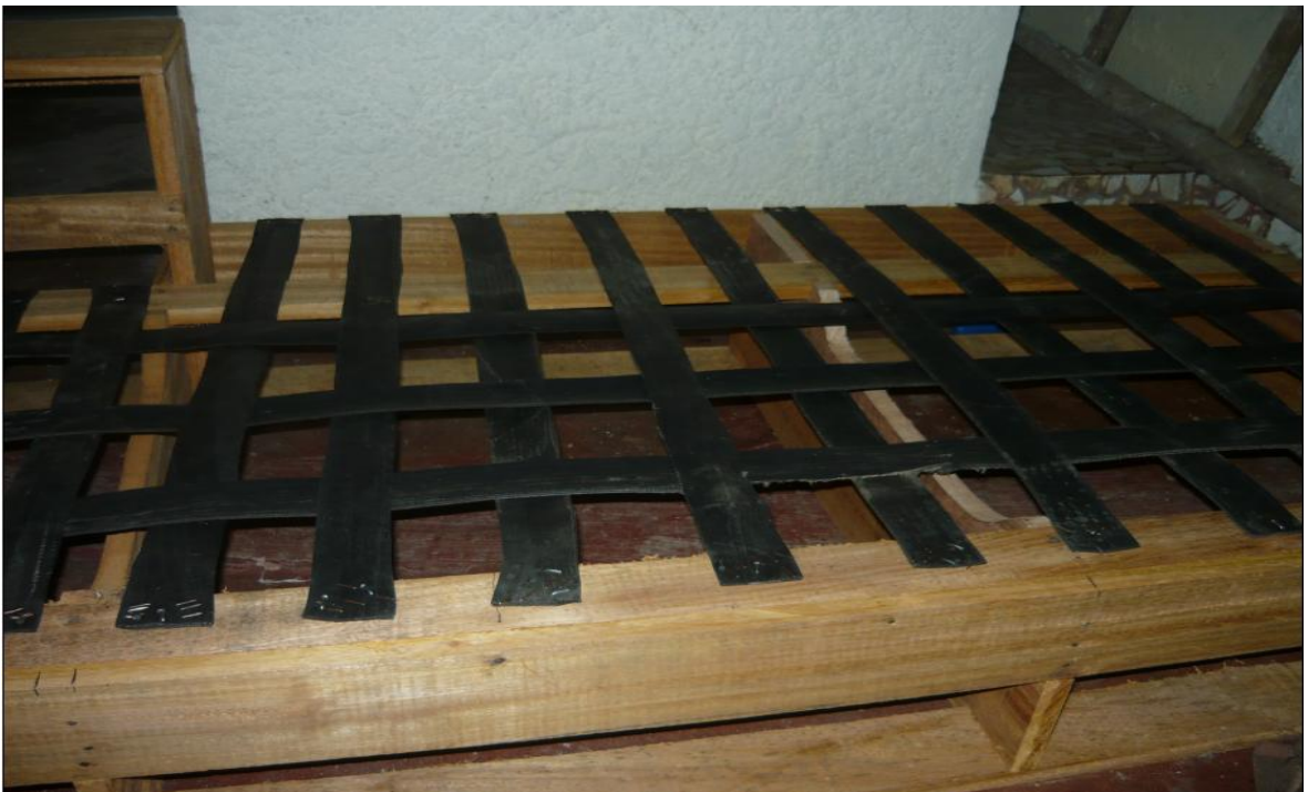
Foto 4. Estructura del mueble (sin tela, lienzos, espumas ni costales)
