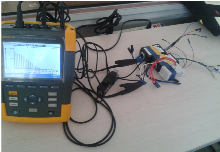
Figura D.4. Power packs en paralelo.
