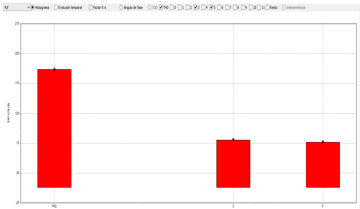
Figura 61. Distorsión armónica total de los power packs conectados en paralelo.
