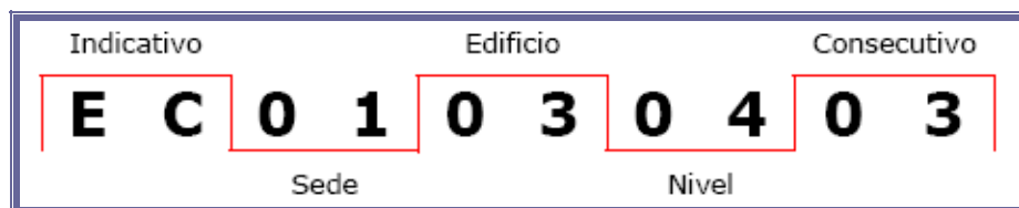
Figura 21. Codificación de elementos constructivos
