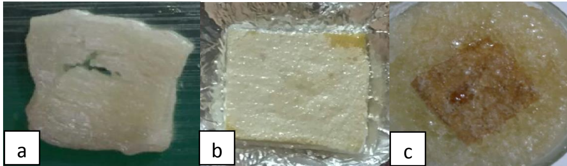
Figura 9. Efecto del tiempo, cantidad de ciclos y presión de vacío en la infiltración de la resina epóxica a la madera balsa luego del tratamiento con peróxido de hidrógeno.
