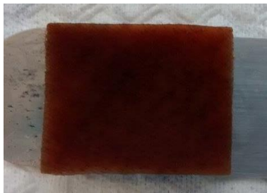
Figura 5. Muestra de madera después de la deslignificación.
