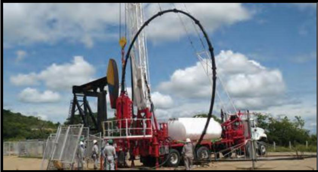
Figura 10. Instalación de varilla continua
