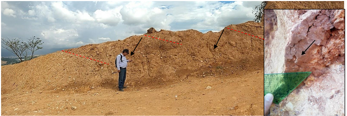
Figura 30. Evidencia de fallamiento normal en depósitos cuaternarios, encontradas en el lote propiedad de Santander. SAS. En la vía al aeropuerto.
