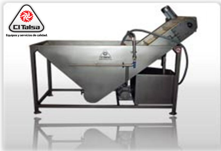
Figura 19. Tanque de lavado
