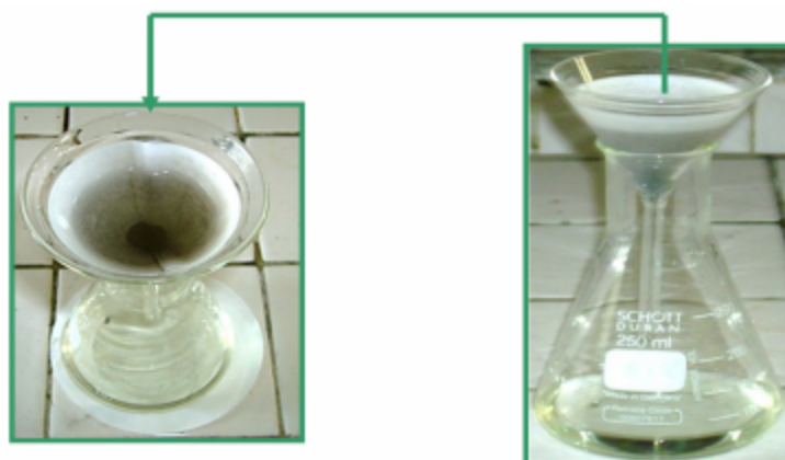
Figura 22. Filtración del producto final del proceso de disolución ácida.
