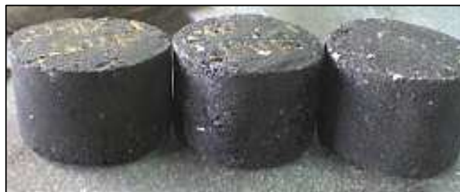
Fotografía 2.6. Probetas tipo Marshall de granulometría (0-25).
