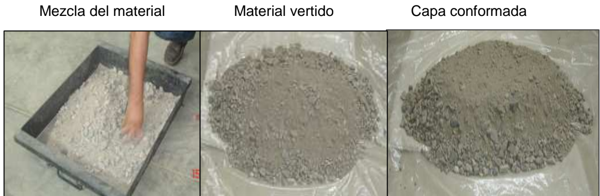
Fotografía 2.3. Proceso de la prueba de segregabilidad del agregado pétreo.
