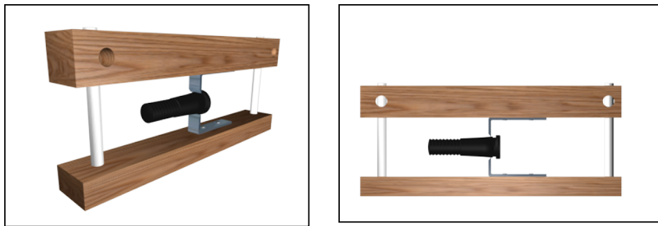
Figuras 18. Dispositivo para pruebas de corte
