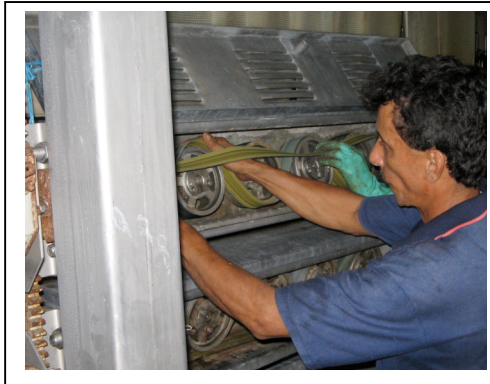
Figura 15. Montaje de bandas de transmisión
