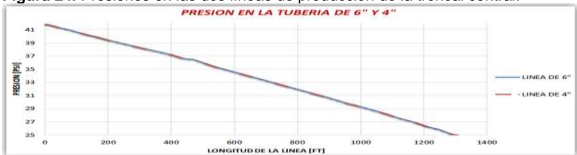
Figura 24. Presiones en las dos líneas de producción de la troncal central.
