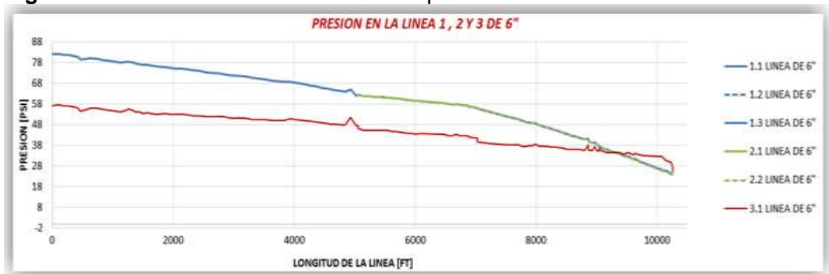
Figura 28. Presiones en las dos líneas de producción de la troncal sur.
