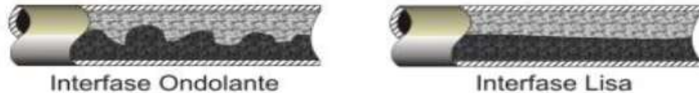
Figura 7. Patrón de flujo estratificado.
