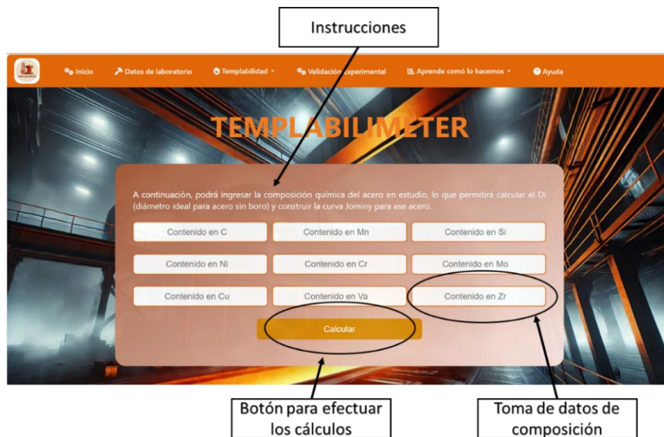
Figura 9. GUI para cálculos de templabilidad basados en la composición química del acero.
