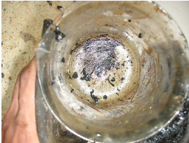
Figura 15. Esgurrimiento producido en presencia de fibras de caucho.
