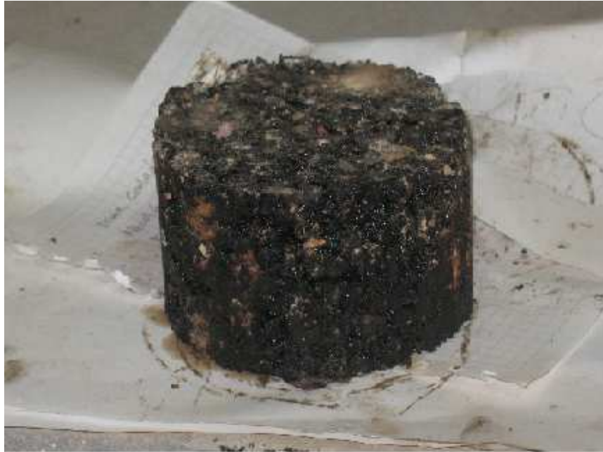
Figura 12. Resultado: probeta tipo SMA
