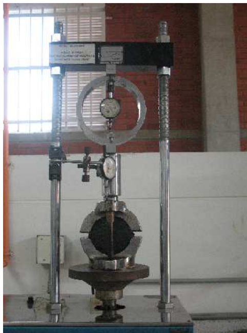
Figura 25. Ensayo Estabilidad y Flujo.
