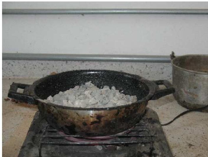
Figura 9. Proceso de calentamiento de agregados
