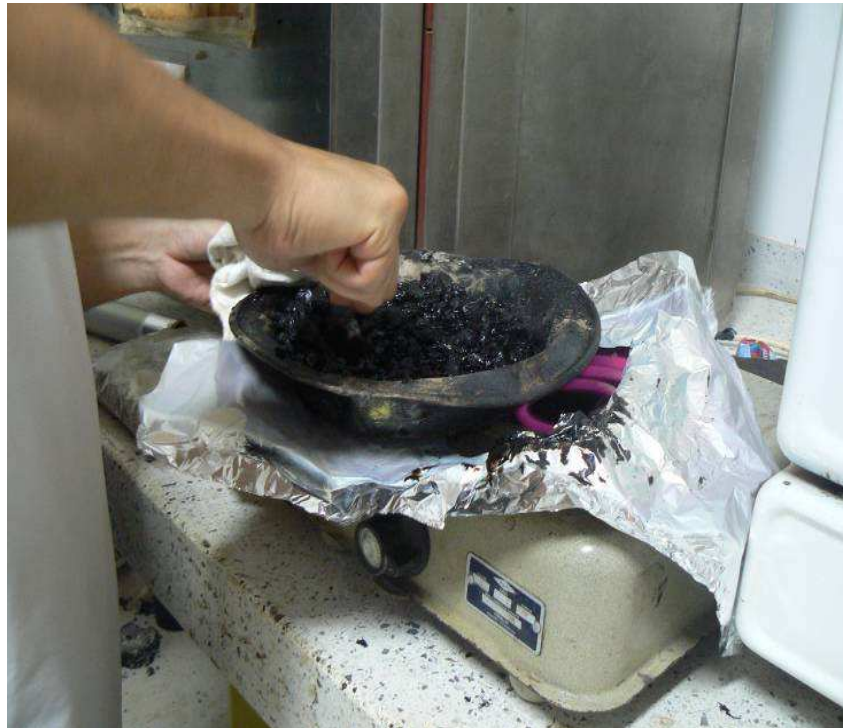
Figura 11. Proceso de compactacion de la probeta.
