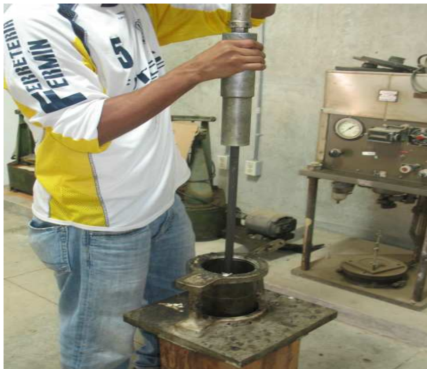
Figura 11. Proceso de compactacion de la probeta.
