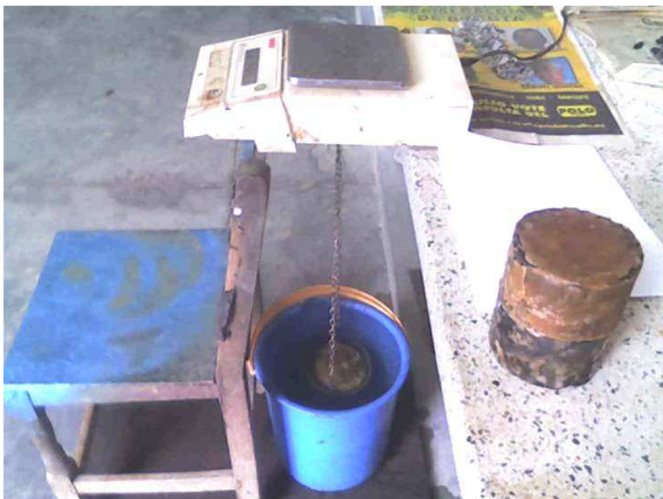
Figura 19. Peso de las probetas parafinadas sumergidas en agua.
