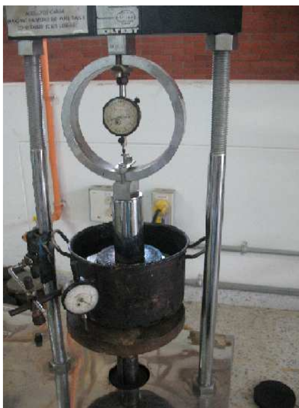
Figura 21. Ensayo módulo elástico.
