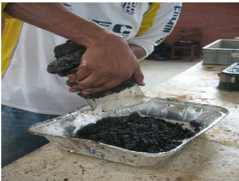
Figura 13. Vaciado de la mezcla tras salir del horno.
