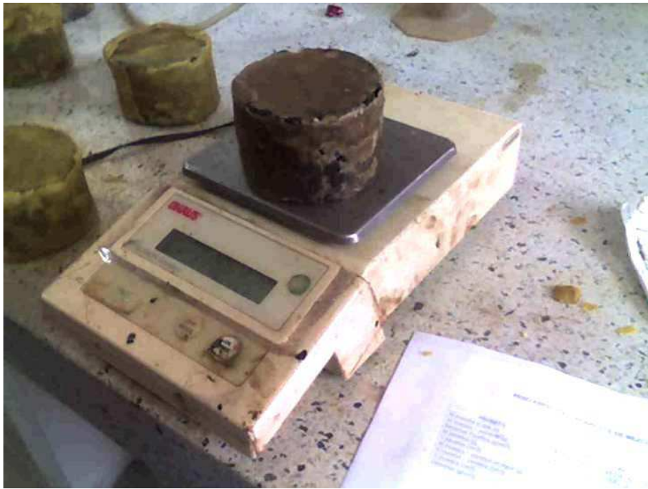
Figura 19. Peso de las probetas parafinadas sumergidas en agua.
