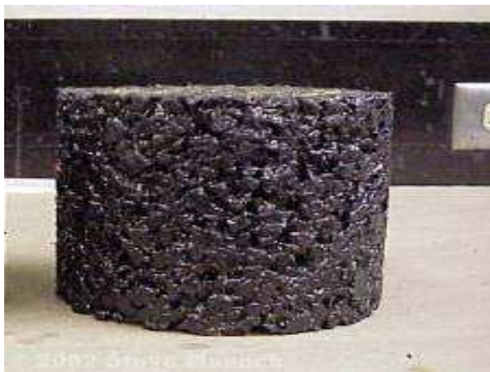
Figura 4. Probeta de una mezcla SMA.
