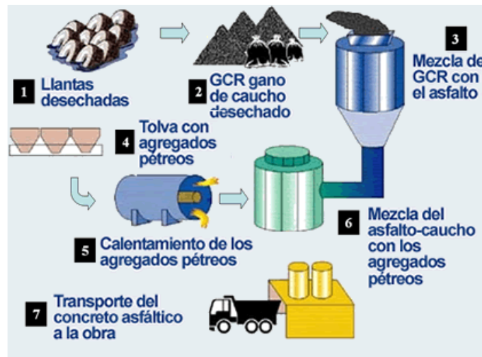
Figura 7. Incorporación del GCR en las mezclas asfálticas, proceso húmedo.
