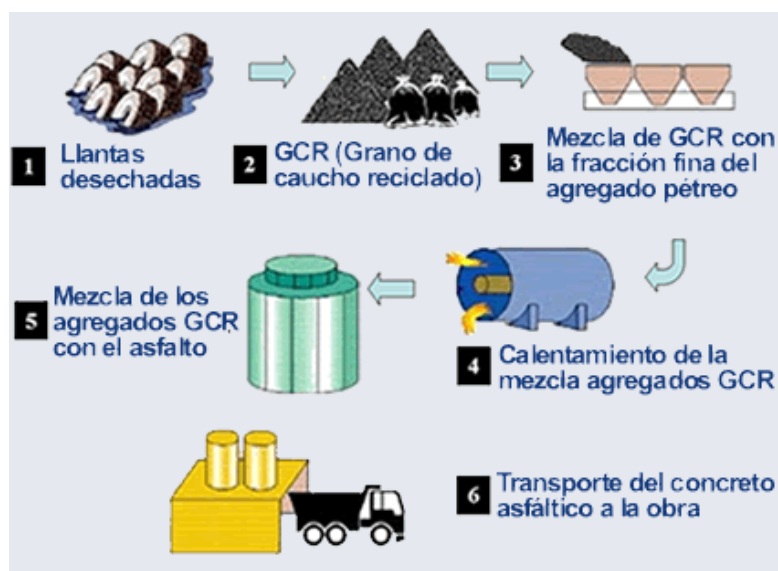
Figura 6. Incorporación del GCR en las mezclas asfálticas, proceso seco.
