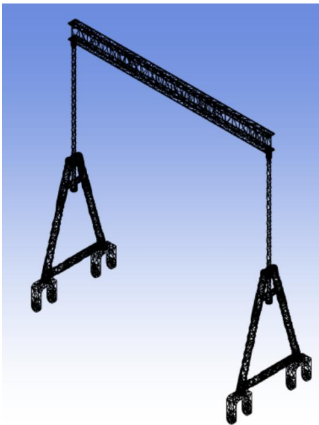
Figura 31. Modelo para análisis modal en Ansys.
