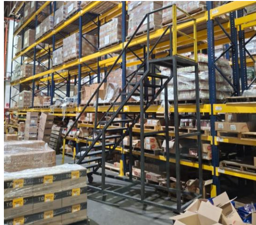
Figura 7 Escalera tipo avión del almacén de producto terminado
