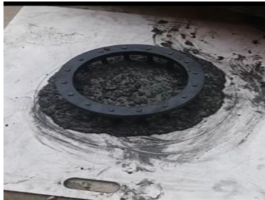
Figura 17. Ensayo J-ring test a/c=0.6 IS=40% ).
