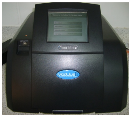
Figura 20. Espectrofotómetro Modulus™ II , microplate reader , 645 N. Turner Biosystems , North Mary Avenue, Sunnyvale, CA, EE.UU.
