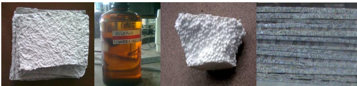
Foto 1. a) Láminas de papel reciclado; b) Xileno Comercial; c) Icopor (EPS); d) Aglomerado con proporción en peso de 65.43:34.57
