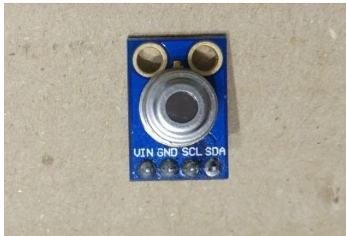
Figura 6. Foto del sensor de referencia GY-906 mlx90614, usado para la medición de temperatura de las muestras dentro de la guía de onda.
