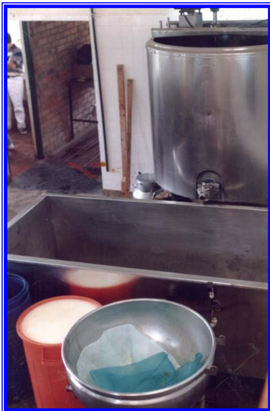
Tanque de Almacenamiento y tina quesera
