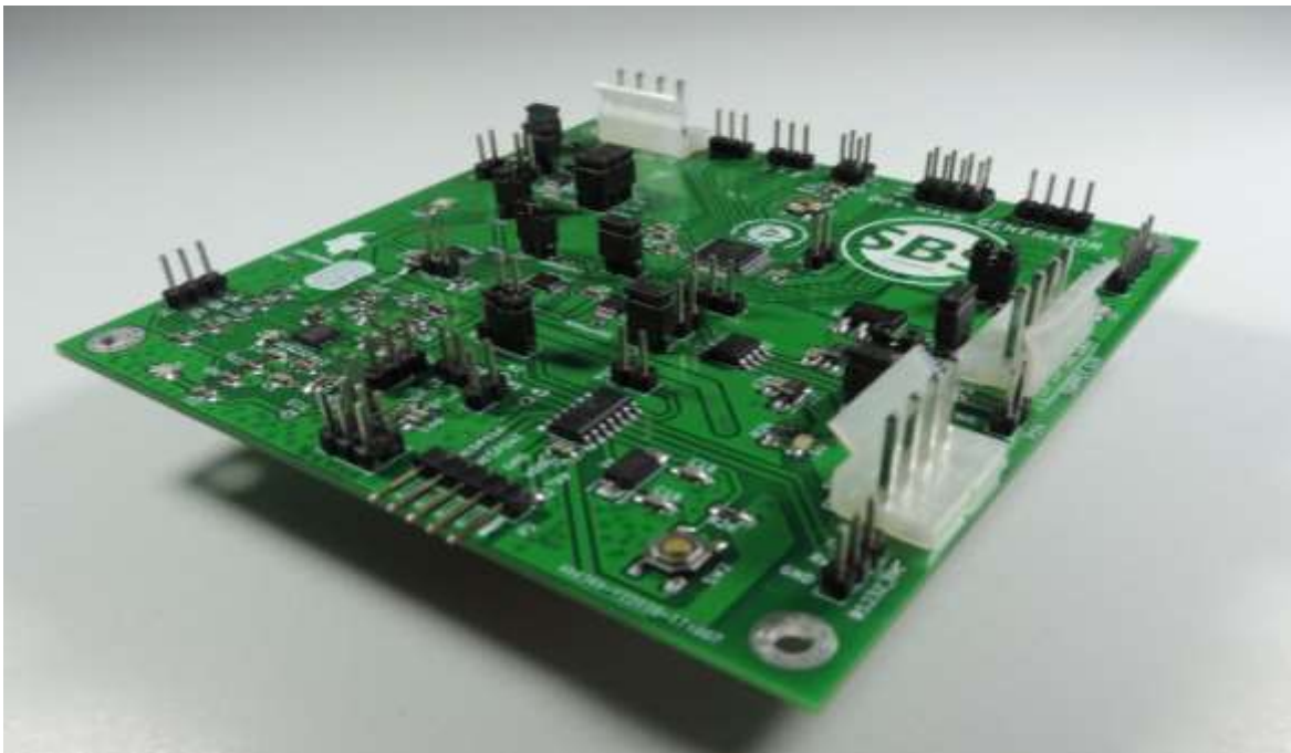
Figura 27. Circuito impreso de módulo generador de señales.
