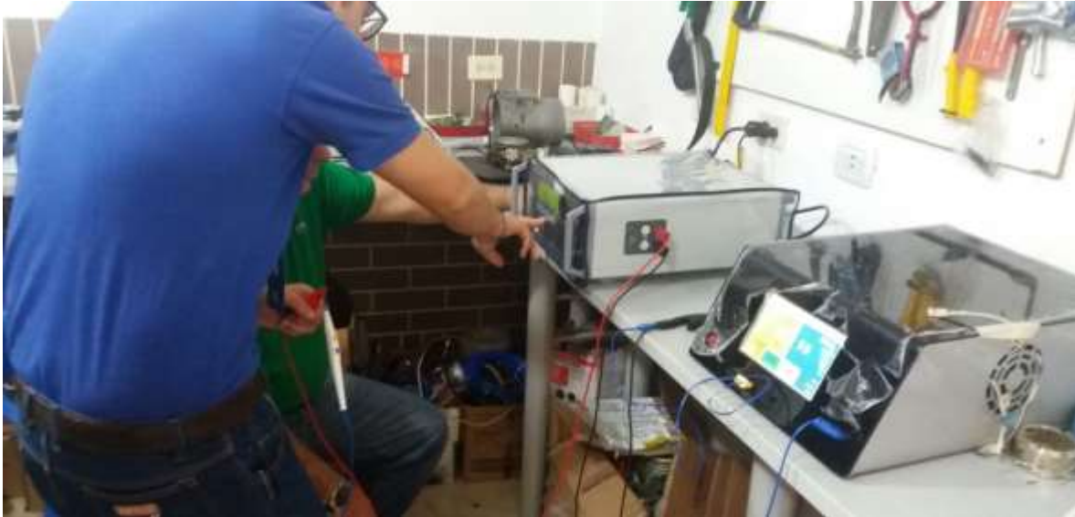
Figura 65. Electrobisturí conectado a QA-ES II Electrosurgery Analyzer para pruebas de potencia.
