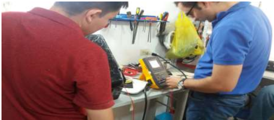
Figura 78. Equipo de electrocirugía conectado a Fluke ESA615.
