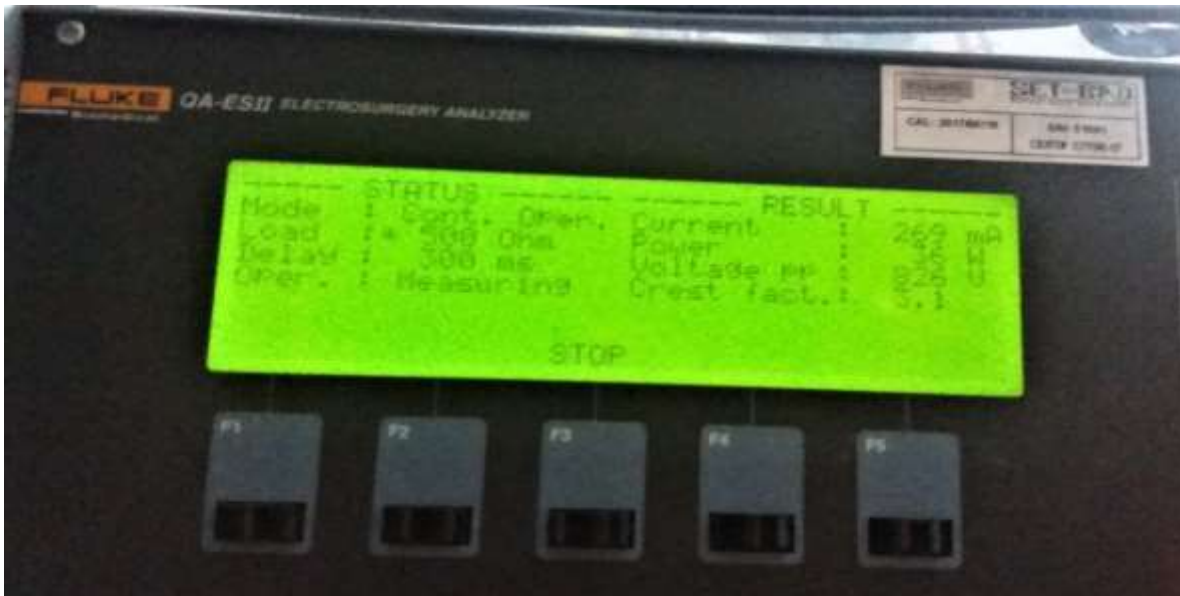
Figura 67. Resultado en pantalla de potencia para 35 Watts.
