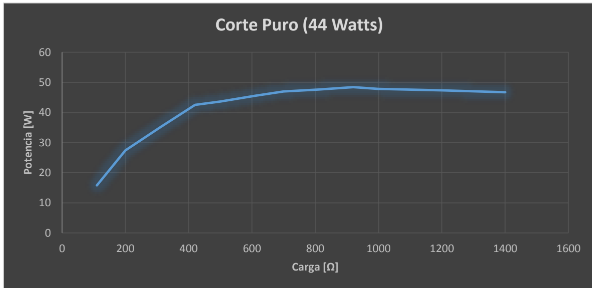
Figura 63. Curva de potencia corte puro 40 Watts.
