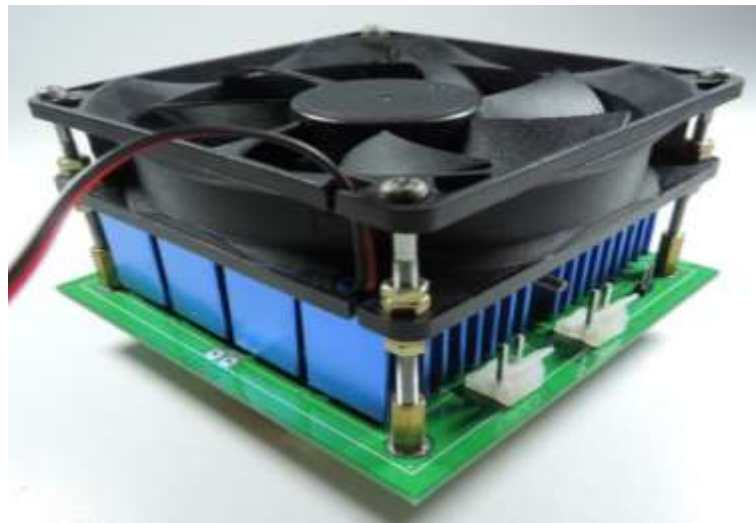
Figura 23. Tarjeta arreglo de mosfets de potencia.
