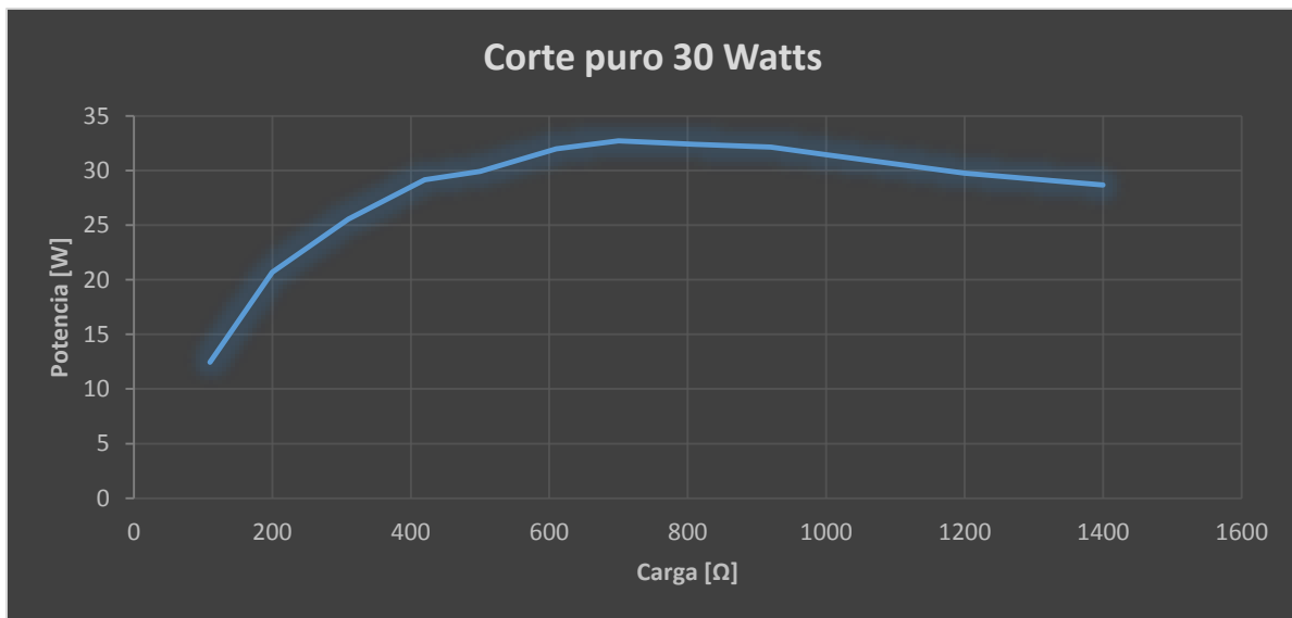
Figura 62. Curva de potencia corte puro 30 Watts.
