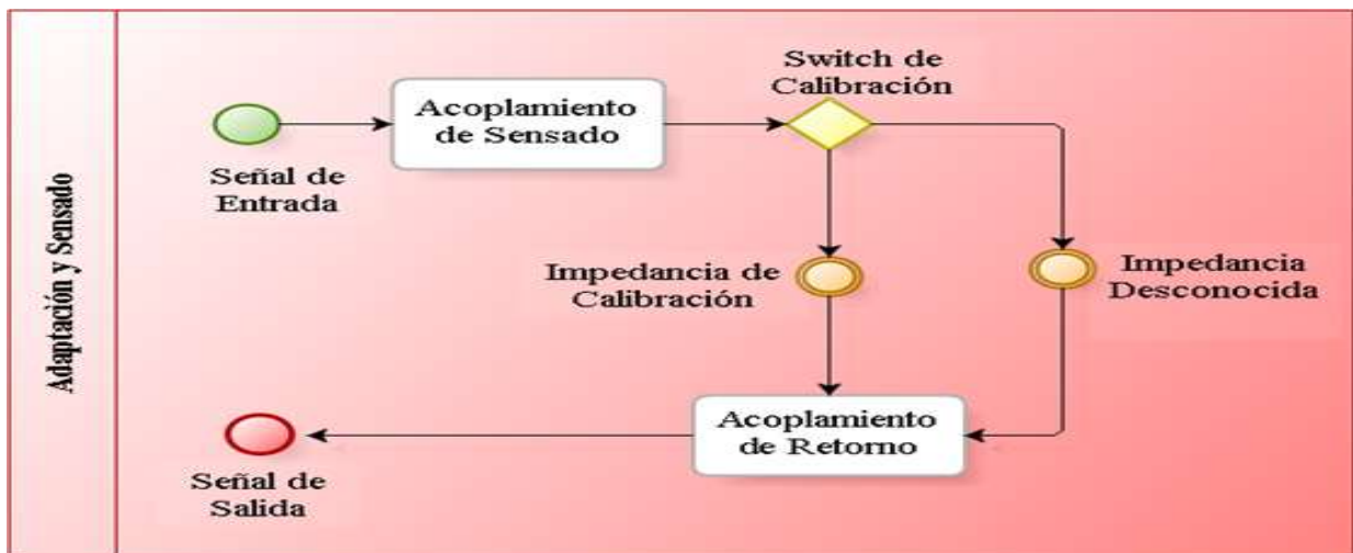
Figura 14. Sistemas de acoplamiento y sensado de bioimpedancia.
