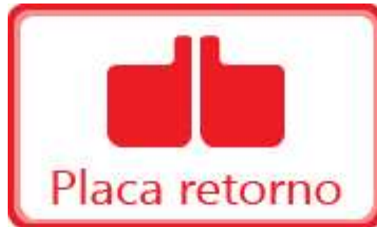
Figura 48. Advertencia Placa de Retorno Ausente o Mal Puesta.
