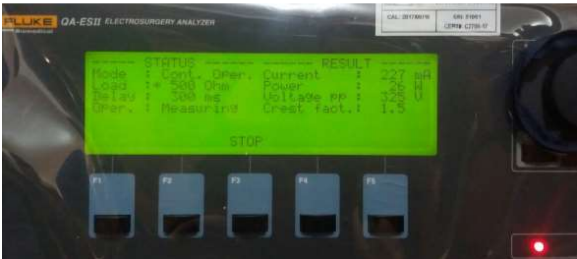
Figura 66. Resultado en pantalla de potencia para 25 Watts.
