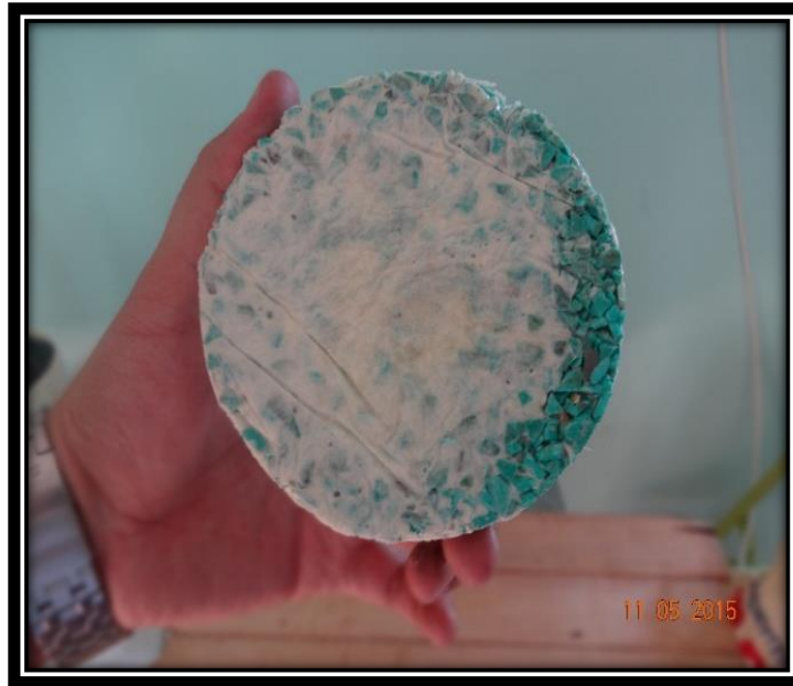
Imagen 5. Posible falla de la mezcla 90gr de PVC y 10 gr. De poliuretano
