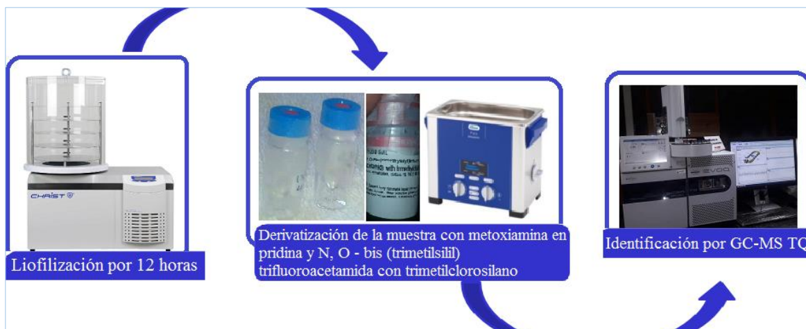
Figura 13. Metodología para la identificación del producto de oxidación.
