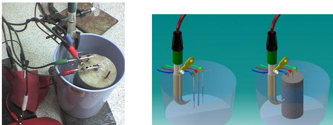
Figura 3. Diagramas esquemáticos de la celda de tres electrodos para ensayos electroquímicos.
