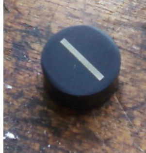
Figura 9. Descripción del montaje de las probetas para análisis metalográfico (Sección longitudinal).
