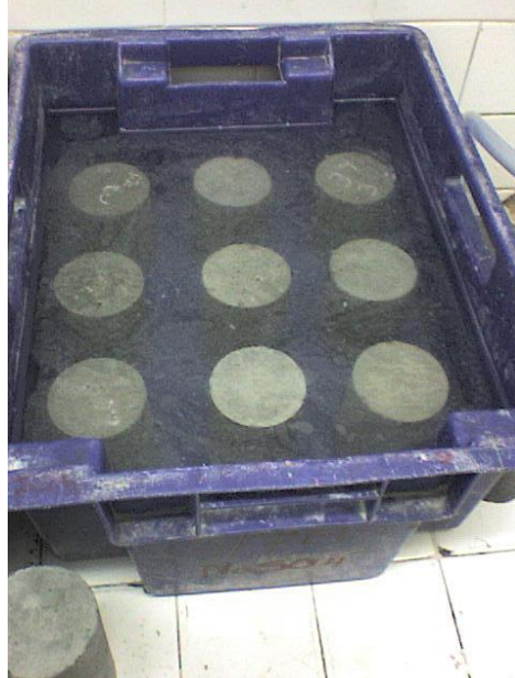
Figura 7. Probetas en etapa de humectación o inmersión en solución de NaCl y Na 2 SO 4
