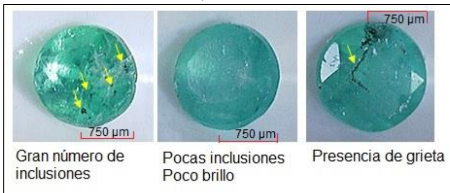
Figura 17. Esmeraldas usadas en la primera colada
