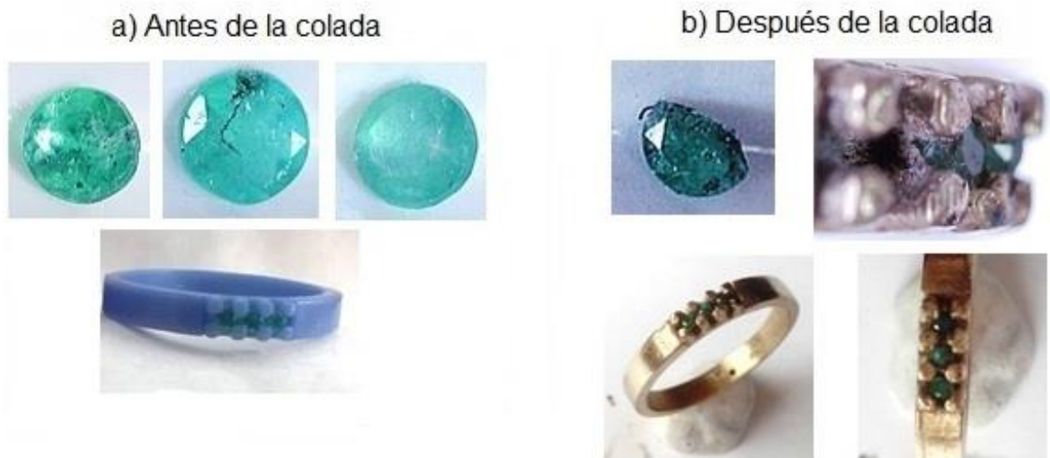
Figura 45. Resultados de la colada final anillo 1
