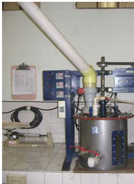
Figura 8. Digestor Hidrolítico Acondicionado
