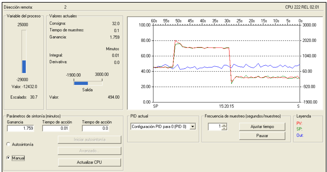
b) Panel de sintonía del PID0, se observa el seguimiento de la señal de retroalimentación LVDT al set point de posición.
