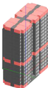
Ilustración 44. Selección de zonas térmicas representativas del edificio para la simulación energética
