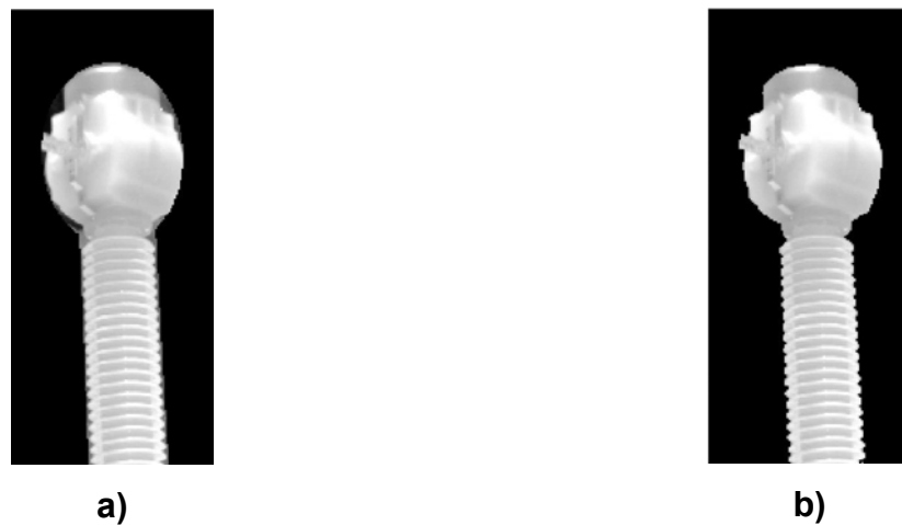
Figura 3.8 Resultado de aplicar la máscara obtenida en la umbralización a un termograma de un CT
