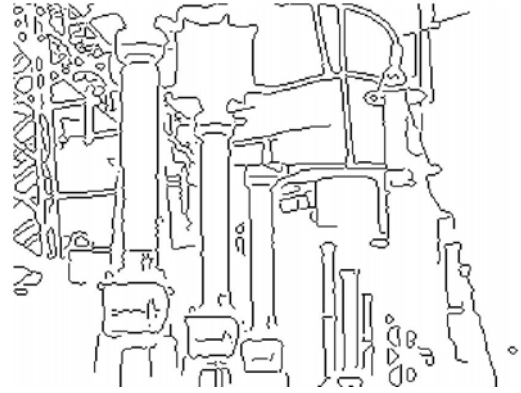
Figura 3.9 Resultado del detector Canny sobre un termograma de PTs
