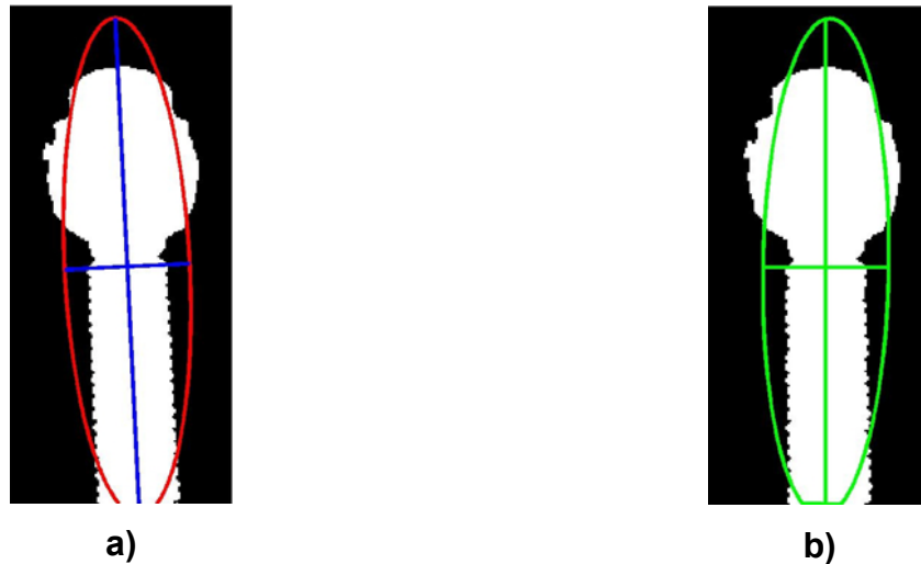
Figura 3.23 Verticalización de la máscara de extracción
