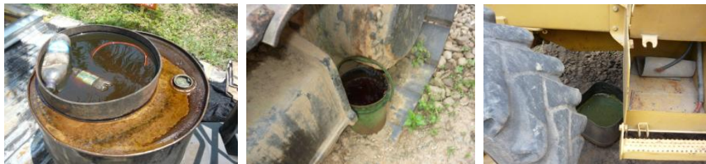
Foto 11. Evidencia depósitos de agua
