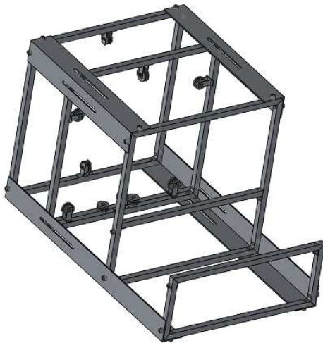
Figura 14. Estructura para la medición de la variable fuerza. Fuente: Autores.
