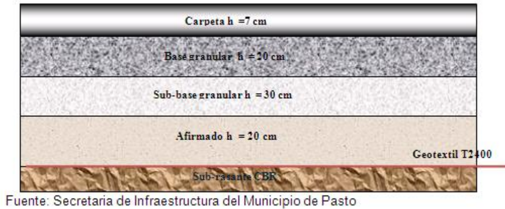
Figura N° 13. Estructura de Pavimento N° 2
