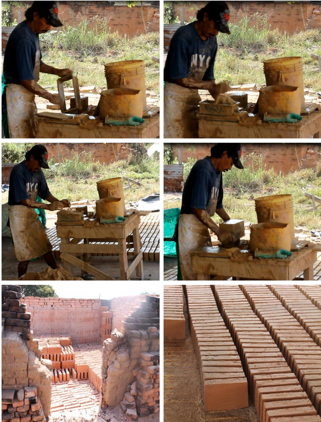
Figura 46. Proceso de elaboración de las unidades de ladrillo cocido.
