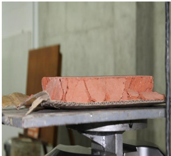
Figura 48. Unidad de ladrillo fallada.
