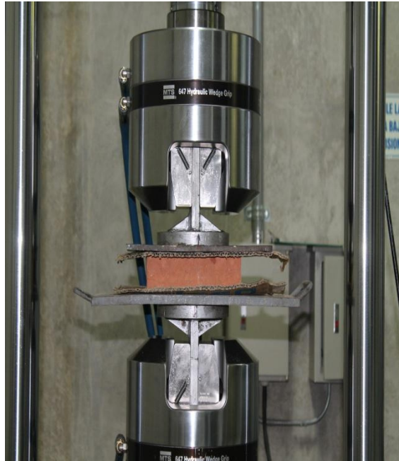
Figura 47. Primera unidad de ladrillo en ensayo a compresión.
