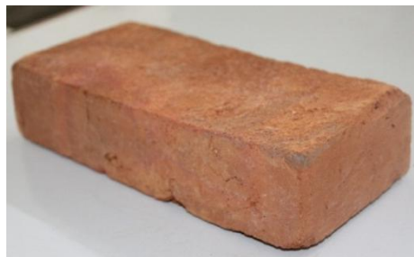
Figura 22. Ladrillo tejar elaborado con arcilla de la vereda Las Llanadas, Girón. Fuente: el autor del proyecto.
