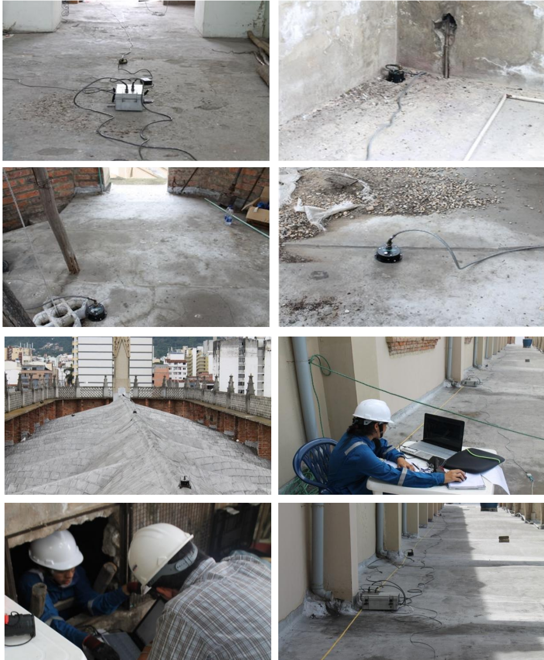
Figura 49. Sensores en las torres, sobre la nave central y naves laterales. Estaciones de trabajo
