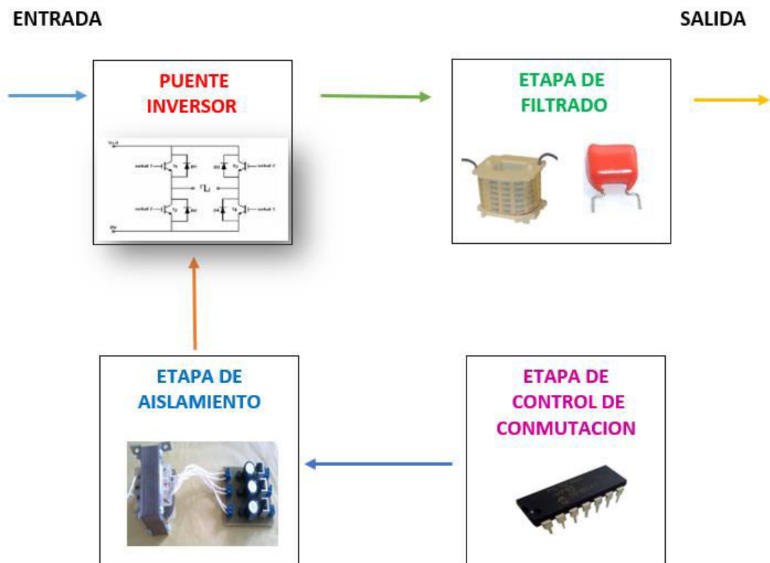
Figura 28. Etapas de diseño y construcción.
