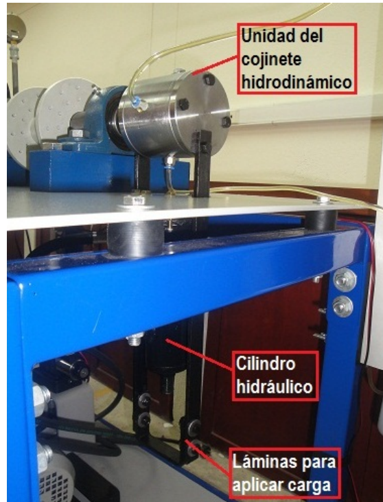
Figura 3.14.: Montaje del sistema de láminas
