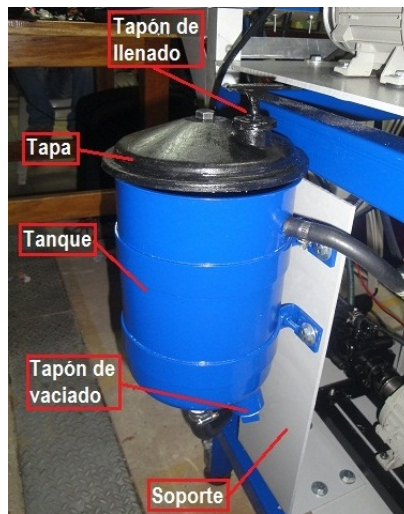
Figura 3.12.: Montaje del tanque hidráulico
