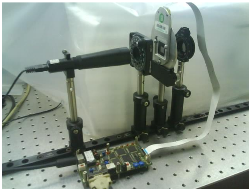
Figura 88. Modelo funcional experimental del codificador sobre ocho MAO's enteros definidos. Fuente Autor.
